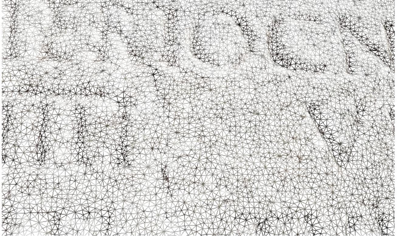
Utilizzando come dato di partenza la nuvola di punti densa, viene costruita una superficie poligonale composta da poligoni i cui vertici sono i punti della nuvola. Di solito si tratta di triangoli, quadrilateri o altri semplici poligoni.
